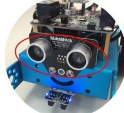
Capteur Ultrasons : capte la distance de l'obstacle.
