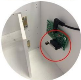
Le microrupteur à galet détecte si la porte est ouverte ou fermée
