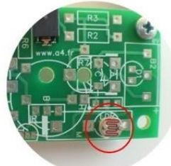
LDR (capteur de lumière) capte la variation de luminosité tout au long de la journée.
