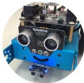
Capteur Ultrason : détection d'obstacle
