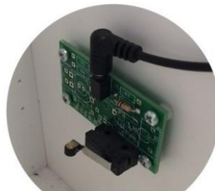
Le micro-rupteur à galet est contacté quand la porte s'ouvre et « appuie sur le galet »
