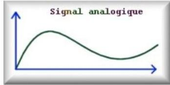
Lorsque l'amplitude de la grandeur porteuse de l'information peut prendre une **infinité de valeurs dans un intervalle de temps donné**, c'est un **signal analogique**.
