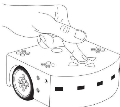
Pour allumer le robot, appuyer et maintenir le doigt sur le rond qui se trouve au centre des flèches jusqu'à ce que le robot émette une mélodie et devienne vert. Cela prend quelques secondes.
